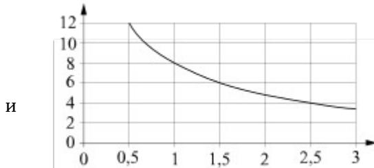
Мощность отопителя в автомобиле регулируется дополнительным сопротивлением. При этом меняется сила тока в электрической цепи электродвигателя: чем меньше сопротивление, тем быстрее вращается мотор отопителя. На графике показана зависимость силы тока от величины сопротивления. На горизонтальной оси отмечено сопротивление в омах, на вертикальной оси — сила тока в амперах. Определите по графику, на сколько омов
