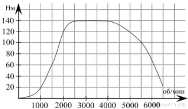
На графике изображена зависимость крутящего момента двигателя от числа его оборотов в минуту. На оси абсцисс откладывается число оборотов в минуту, на оси ординат — крутящий момент в Н·м. Скорость автомобиля (в км/ч) приближенно выражается формулой  $v = 0,036n$ , где  $n$  — число оборотов двигателя в минуту. С какой наименьшей скоростью должен двигаться автомобиль, чтобы крутящий момент был не меньше 120 Н·м? Ответ дайте в километрах в час.
